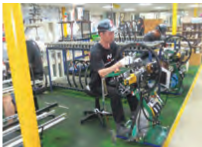
JoytechではFactorホイールの初期製造工程を自動化しているが、熟練工がホイールの許容誤差を念入りに調整していく。
