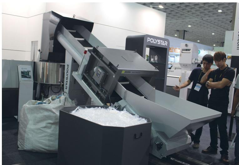
En Taipei Plas, Polystar presentó un sistema de reciclaje en tres etapas: corte, extrusión y peletización, que es capaz de procesar plásticos recuperados rígidos y flexibles.
